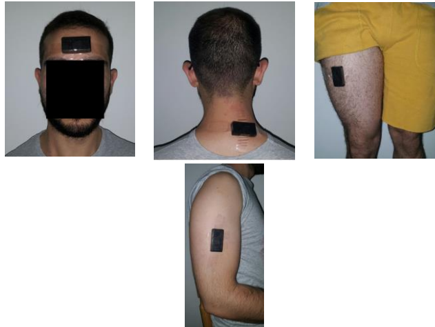
Figura 4. Partes del cuerpo donde se colocan los acelerómetros
