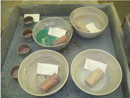
Figura 28. Fotografía de las muestras ya falladas en la máquina de compresión inconfiada.
