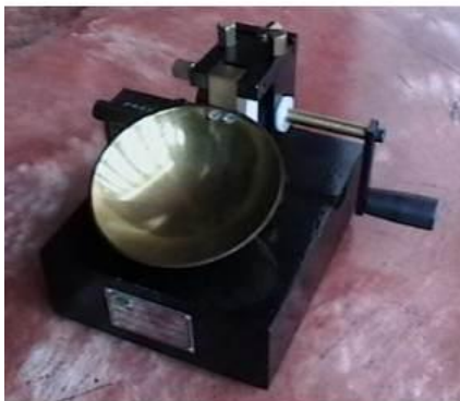
Figura 25. Fotografía de la copa de Casagrande para estimar el límite líquido de las muestras de suelo. (Hernández, 2011)
