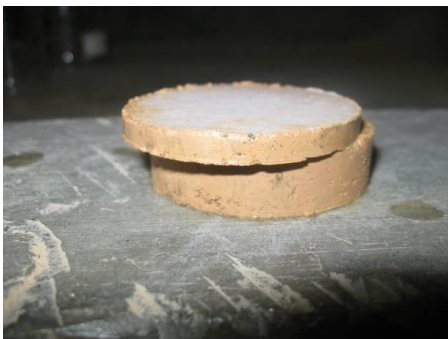
Figura 27. Fotografía de una muestra luego de fallarla en la máquina de corte directo.
