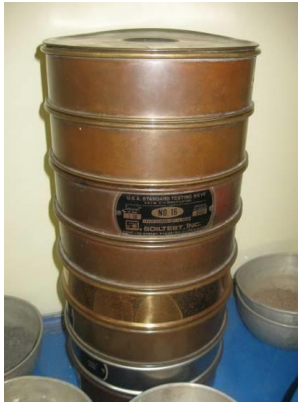
Figura 24. Fotografía de las mallas utilizadas en el proceso de clasificación.
