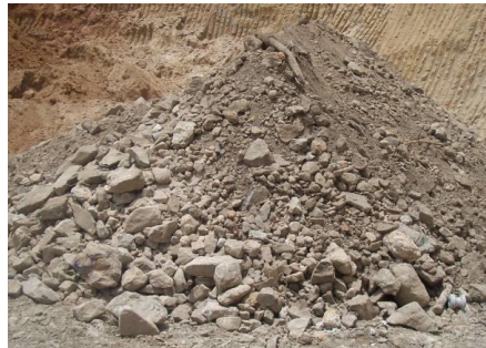
Figura 36. Material a utilizar como relleno para el muro de suelo reforzado. (PH Pirris, 2011).
