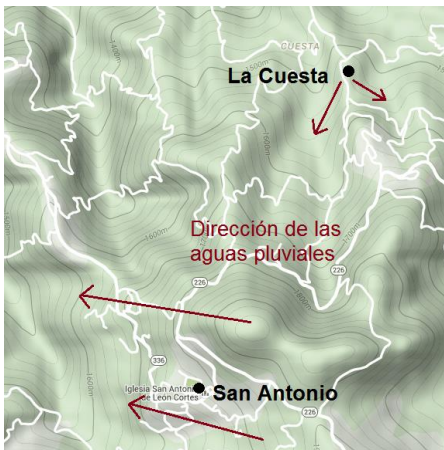
Figura 9. Topografía de la zona de estudio en San Antonio además se representa la dirección de las aguas; los puntos negros representan la ubicación de ambos muros. (Adaptado de Google maps, 2015)
