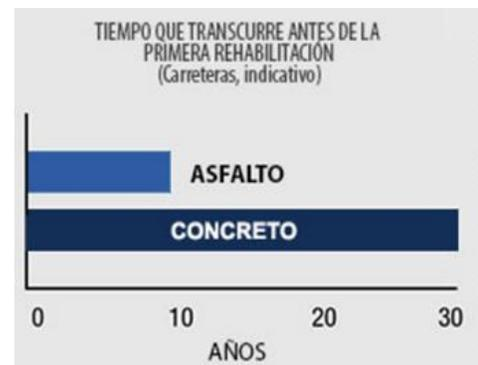
Figura 20. Diferencia del tiempo de primera rehabilitación. Fuente: CEMEX (2011).
