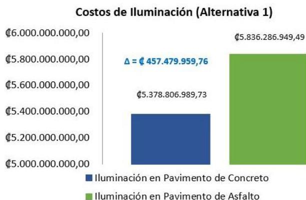
**Figura 37.** Comparación de costos de la iluminación entre ambos pavimentos (Alternativa 1). Fuente: Elaboración propia (2016).
