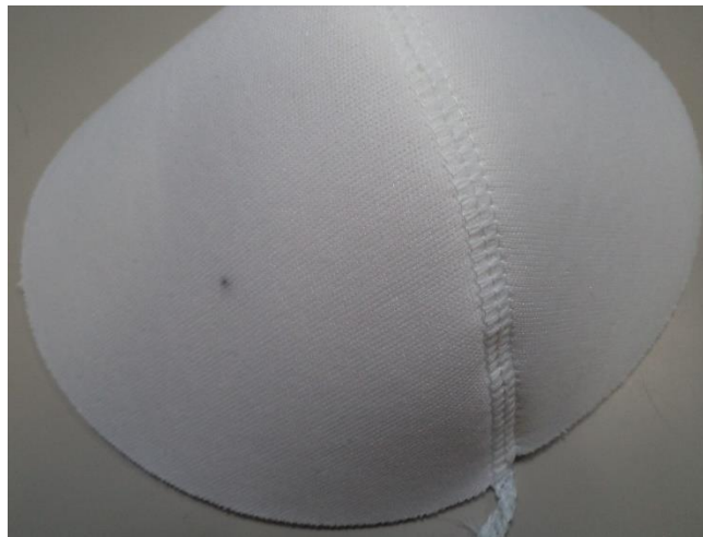
Figura 8. Copa confeccionado con una tela defectuosa
