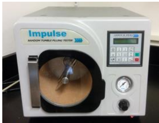
Figura 82. Equipo utilizado en la determinación de la resistencia a la formación de pilling
