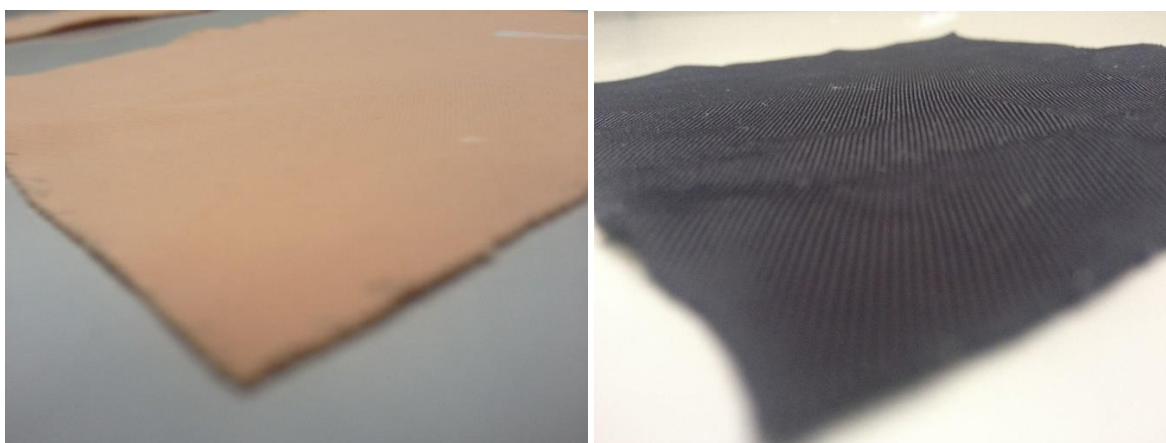
Figura 78. Pilling sufrido por las muestras de la tela de Darlington Brothers negra (derecha) y coñac (izquierda) debido a la prueba ejecutada durante 30 minutos
