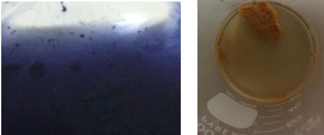
Figura 22. Muestras de la tela Taubert negra (izquierda) y coñac (derecha) en una disolución de ácido sulfúrico al 70% después de 2 horas.
