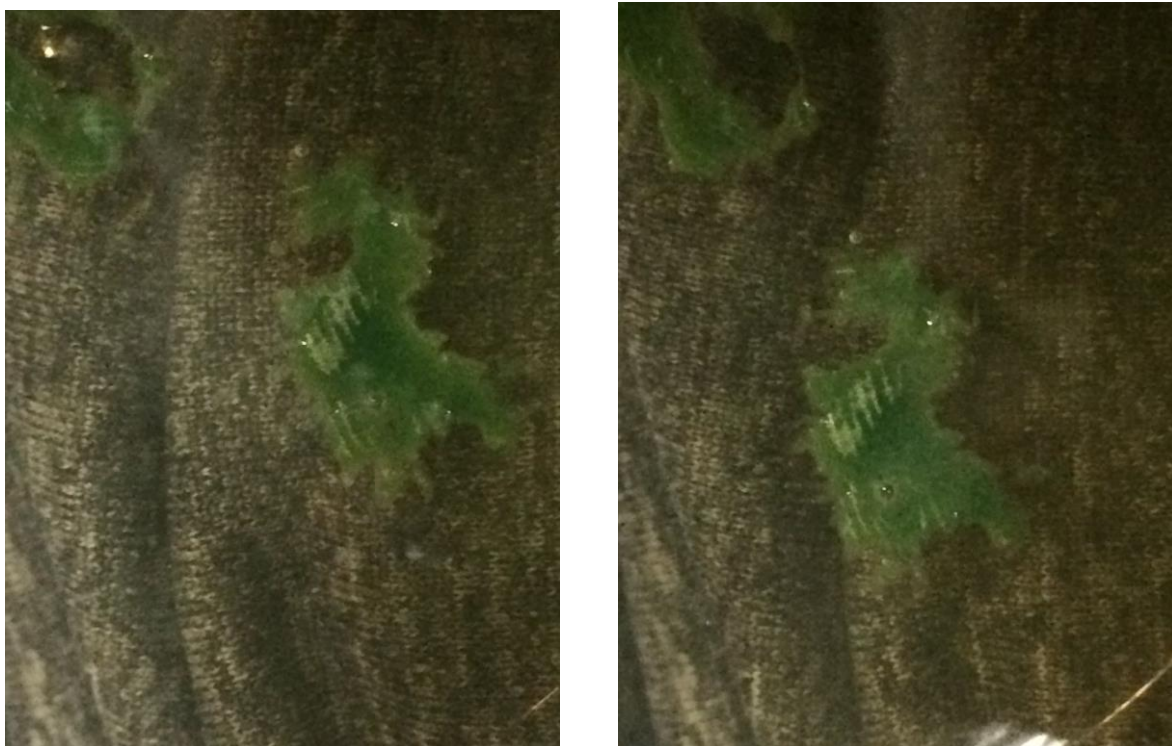
Figura 24. Muestras de tela Darlington en una disolución de ácido clorhídrico al 20 % después de 2 horas
