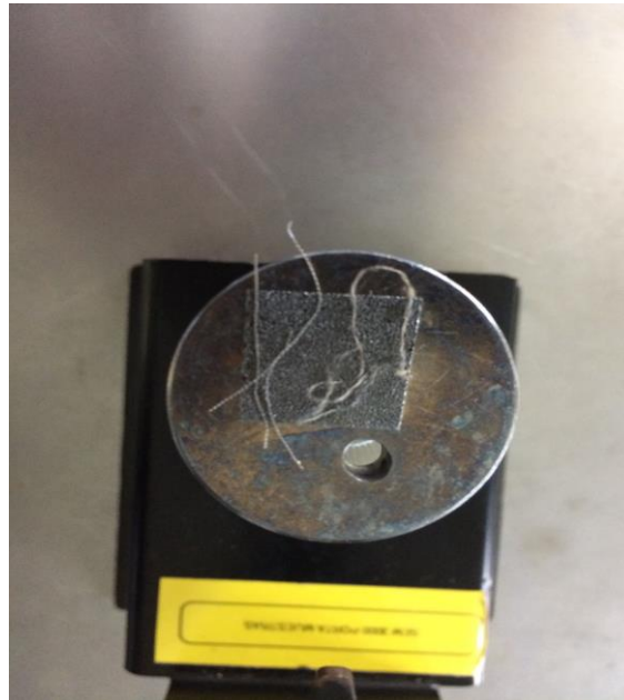
Figura 25. Disposición de hilos supuestamente individuales dentro del porta-muestras del microscopio electrónico de barrido
