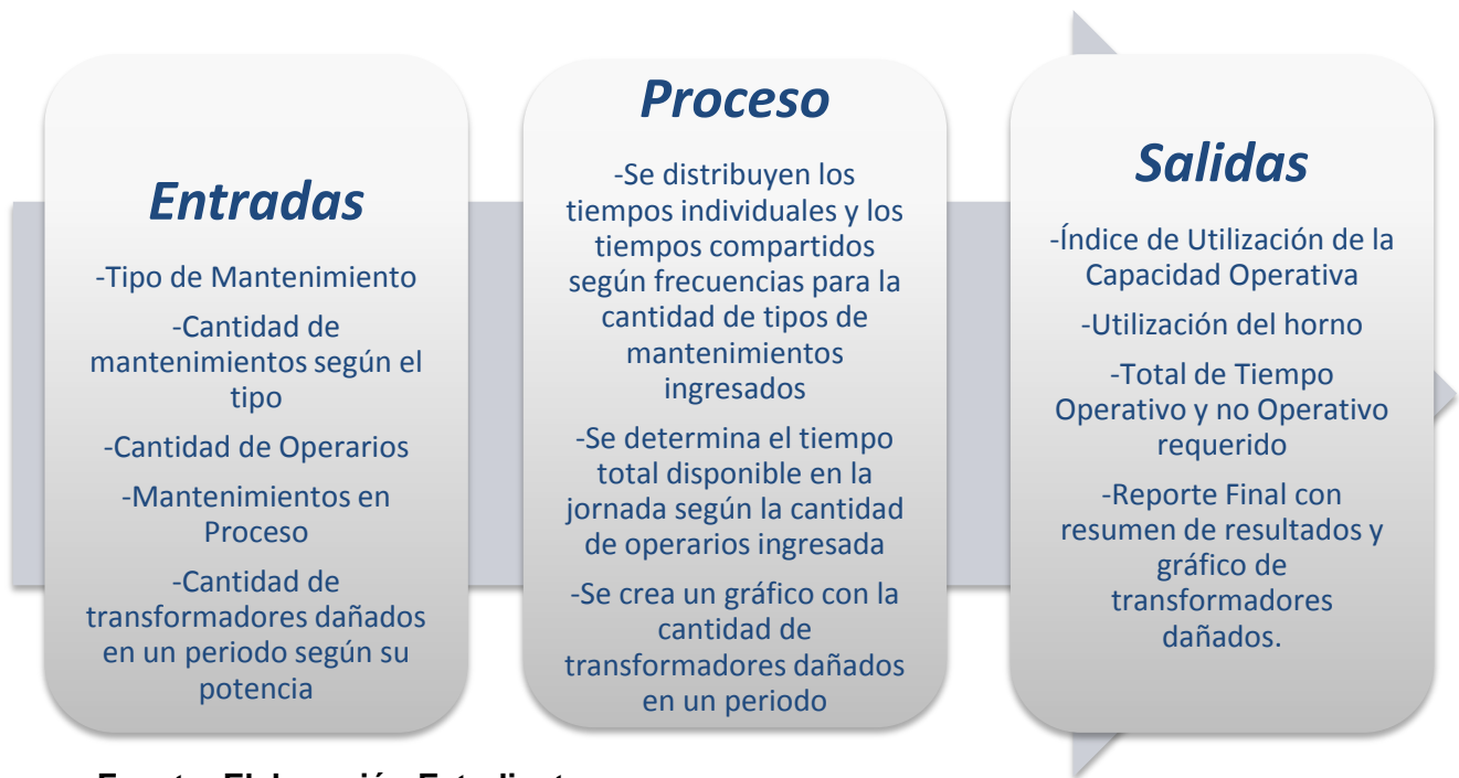
Figura No. 52 Resumen de Entradas, Proceso y Salidas del Modelo de Cálculo de Capacidad para el Taller Eléctrico
