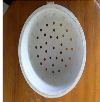
Colador entre medios filtrantes
