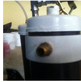
Salida de gas de filtro
