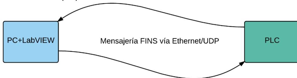
Figura 4.11. Método de adquisición de datos entre PC y PLC
