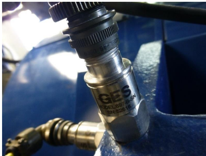
Figura 5.7 Acelerómetro instalado en los Aerogeneradores
