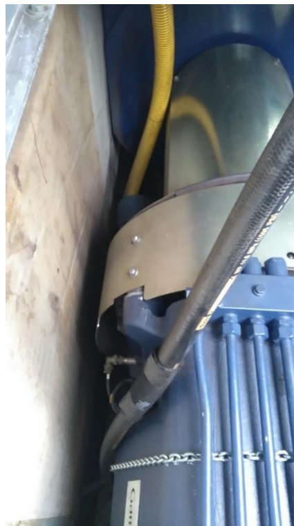
Figura A4.3 Sensor Acelerómetro de la Caja Multiplicadora en posición horizontal
