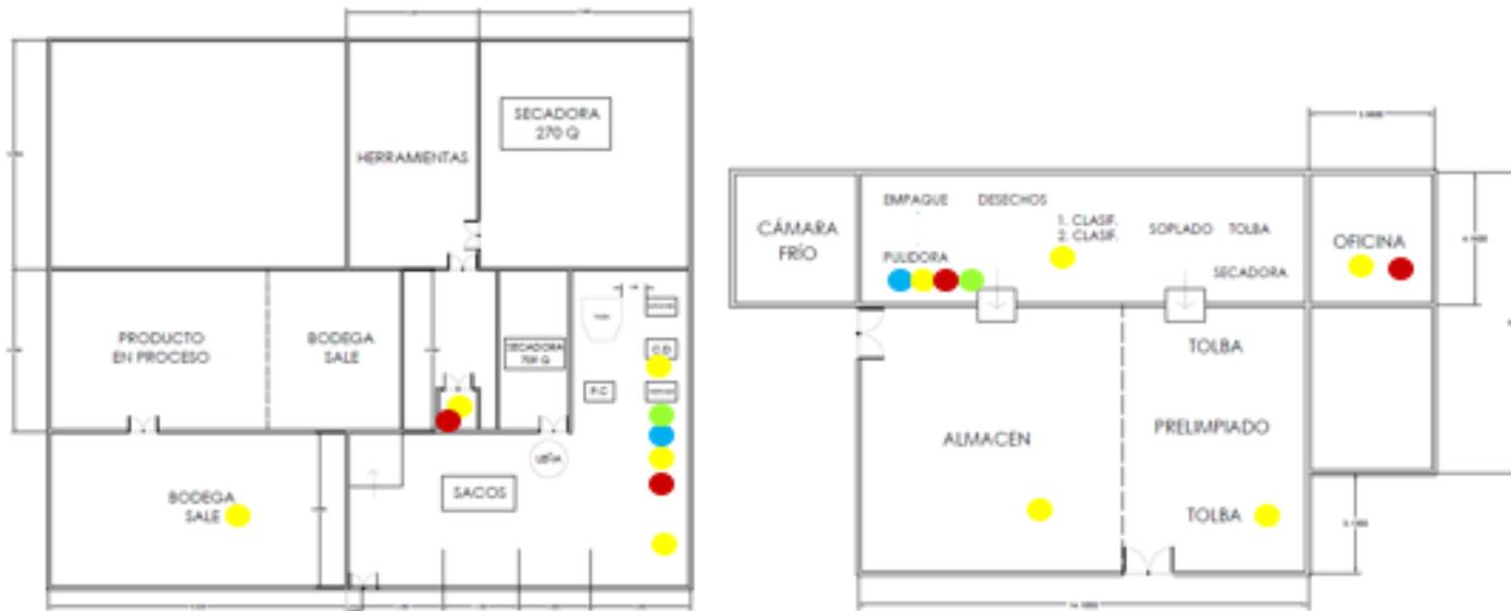
Figura 8. Puestos de medición en las plantas de Concepción de Pilas y El Águila respectivamente
