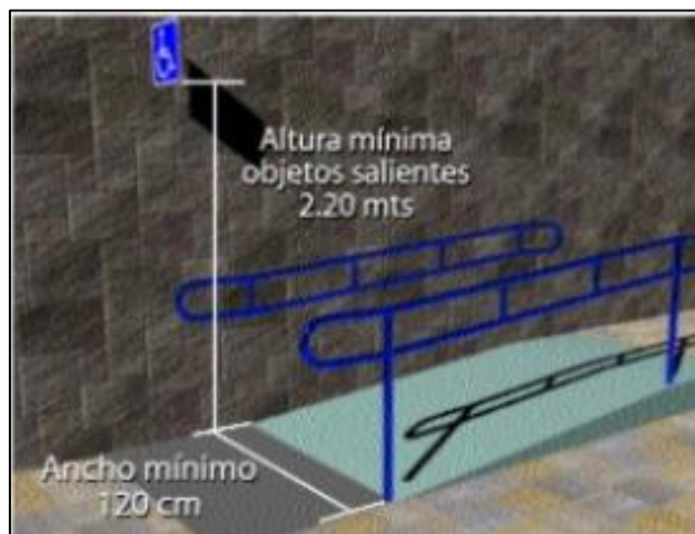
Figura V.10. Identificación de las rampas accesibles mediante el uso del SIA
