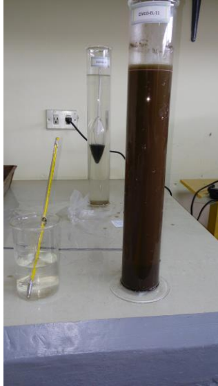
Figura 13. Disolución de material al momento de realizar las mediciones del hidrómetro. (Autor)
