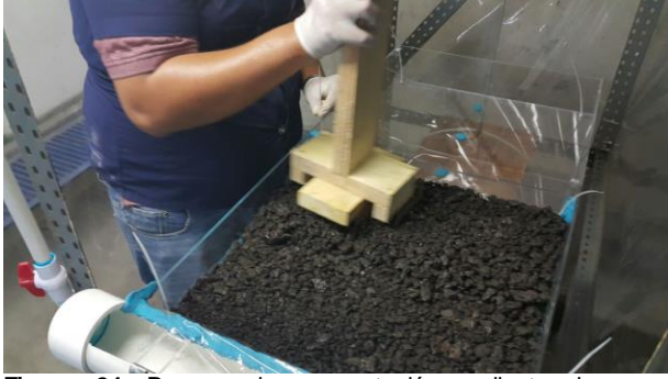
Figura 24. Proceso de compactación mediante el mazo artesanal. (Autor)
