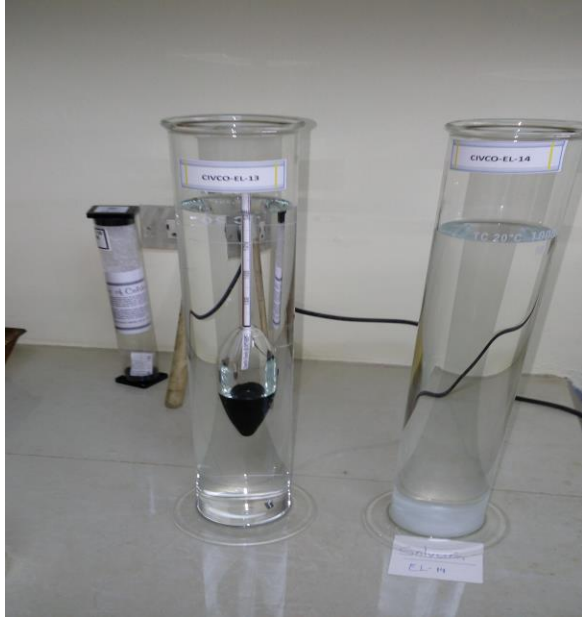
Figura 10. Izquierda hidrómetro 151H sumergido en agua, derecha mezcla de disolución de hexametáfosfato de sodio. (Autor)
