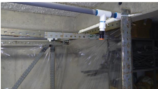
Figura 23. Aspersor utilizado en el simulador hidrogeológico 6 series VANmarca RainBird. (Autor)
