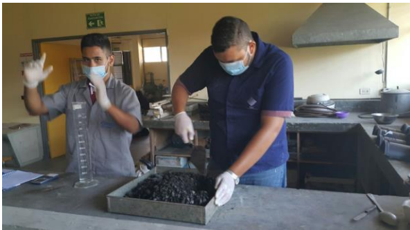
Figura 27. Proceso de homogenización e hidratación del material, antes de realizar el ensayo de erosión. (Autor)
