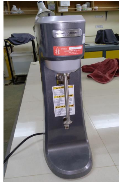
Figura 12. Mezclador utilizado en el ensayo de granulometría por hidrómetro. (Autor)
