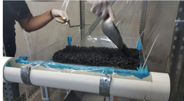
Figura 29. Colocación y compactación del material en la bandeja del simulador hidrogeológico. (Autor)
