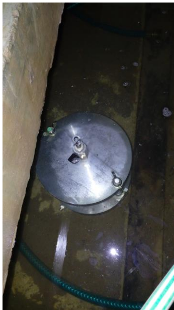
Figura 16. Permeámetro mientras se saturaba en la pila de agua por 24 horas. (Autor)
