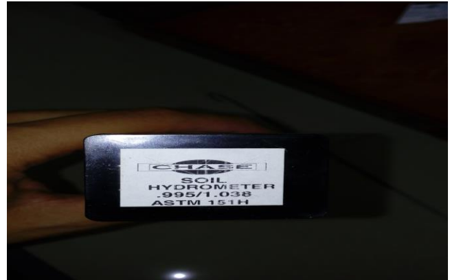
Figura 9. Hidrómetro 151H utilizado en el ensayo de análisis granulométrico. (Autor)
