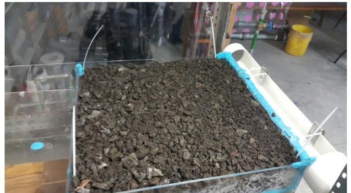
Figura 30. Material compactado y en reposo por 16 horas antes del ensayo. (Autor)
