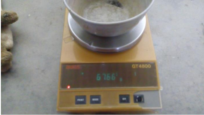
Figura 33. Toma de peso seco del material erosionado. (Autor)
