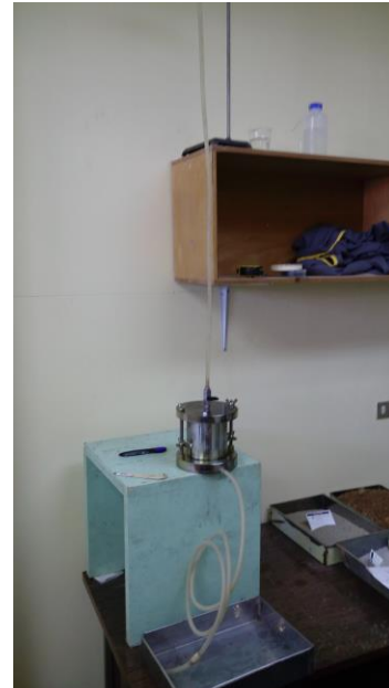
Figura 17. Montaje de la prueba de permeabilidad. (Autor)
