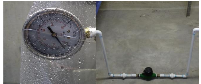
Figura 21. Manómetro de 100 psi y fluxómetro utilizado en el simulador hidrogeológico. (Autor)
