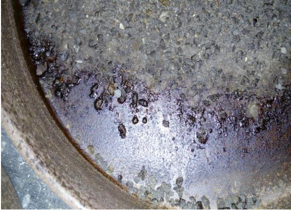
Figura 8. Material quemado en el horno, al calcular peso seco en gravedad específica. (Autor)
