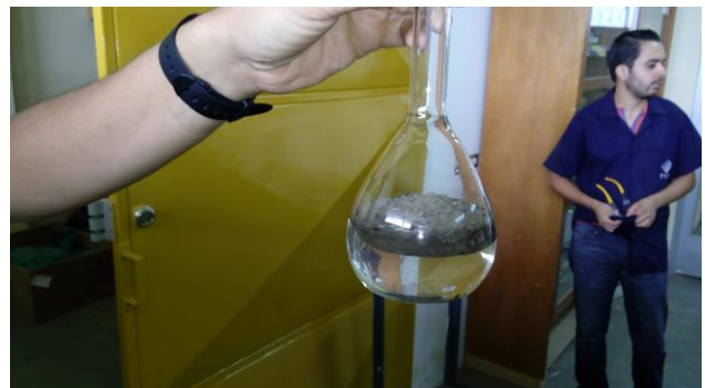
Figura 7. Material suspendido por el agua, al momento de llenar el picnómetro con el agua destilada. (Autor)
