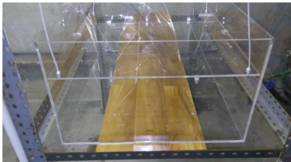
Figura 20. Bandeja fabricada para el simulador hidrogeológico. (Autor)
