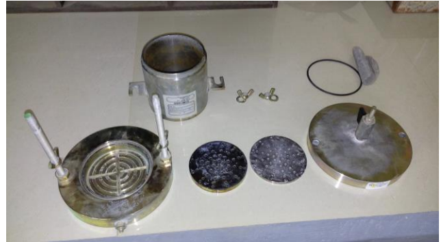
Figura 14. Permeámetro utilizado para el ensayo de permeabilidad. (Autor)
