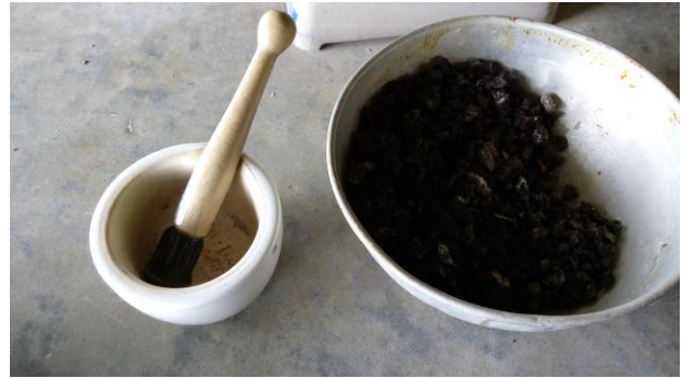
Figura 6. Proceso de molienda del material para ser utilizado en el ensayo de Límites de Atterberg y Gravedad Específica. (Autor)
