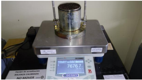
Figura 15. Pesaje del permeámetro más el material moldeado. (Autor)
