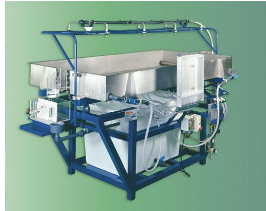
Figura 18. Sistema de hidrología ambiental Armfield S12MKII. (discoverarmfield.com)
