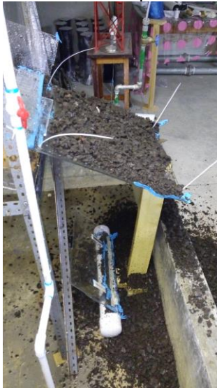
Figura 25. Falla de la bandeja del simulador hidrogeológico. (Autor)
