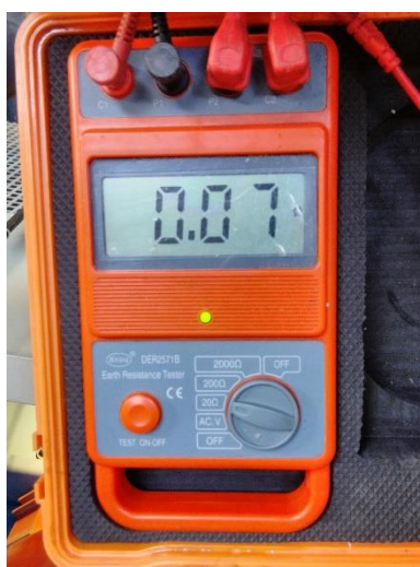
Figura 14. Medición de la malla de tierras principal desconectada de la estructura
