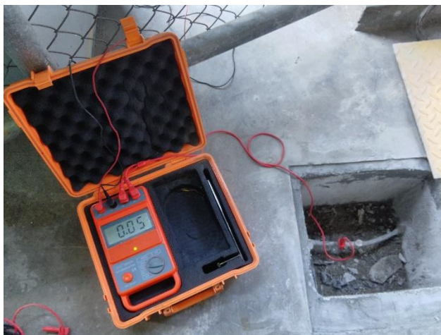
Figura 13. Medición de la malla de tierras principal unida a la estructura
