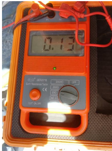
Figura 12. Medición de la malla de tierras secundaria pegada a la estructura
