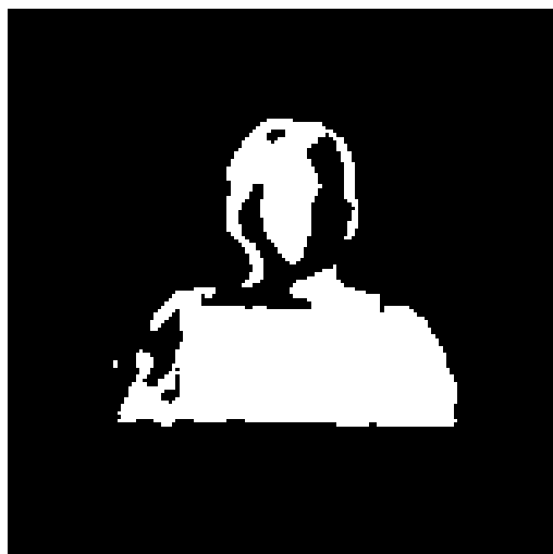
Figura 31: Máscara resultado de realizar substracción de fondo (Creado por el autor en Octave)
