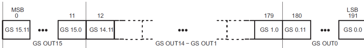
Figura 6.19. Estructura de los datos en el modo GS.
