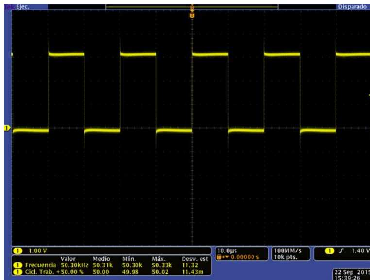
Figura A.1. PWM a 50% de ciclo de trabajo y a 50 kHz.
