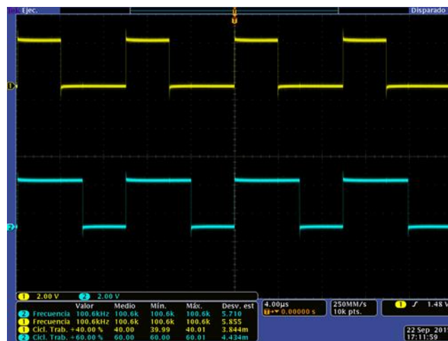
Figura A.5. Dos PWM a 100 kHz y con ciclo de trabajo de 40% y 60%.
