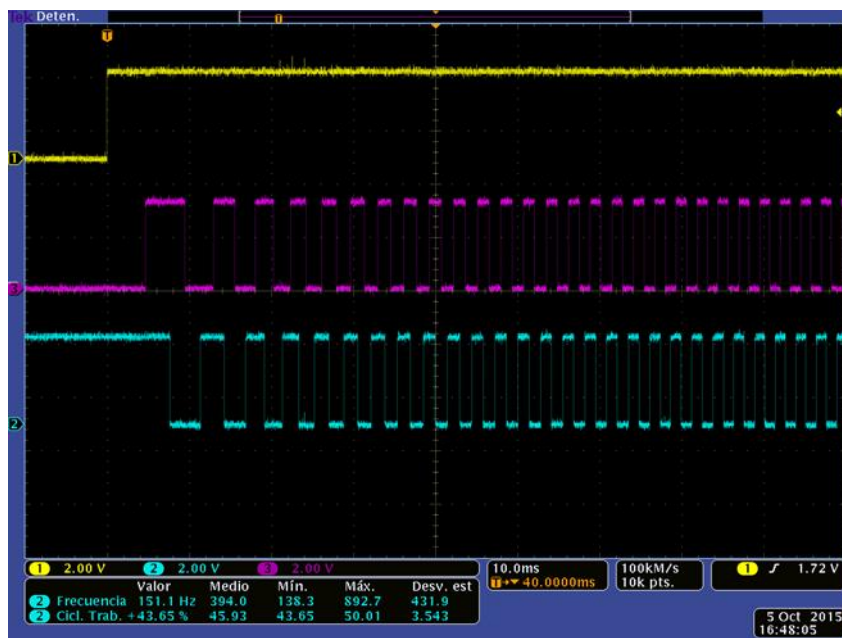
Figura 7.16. Forma de onda obtenida como salida del encoder en la primera prueba.
