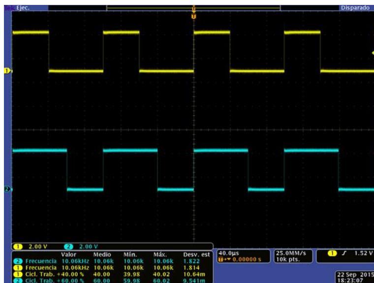
Figura A.7. Dos PWM a 10 kHz y con ciclo de trabajo de 40% y 60%.
