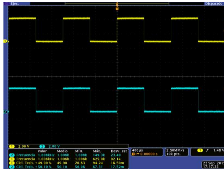
Figura A.6. Dos PWM a 1 kHz y con ambos ciclo de trabajo de 50%.
