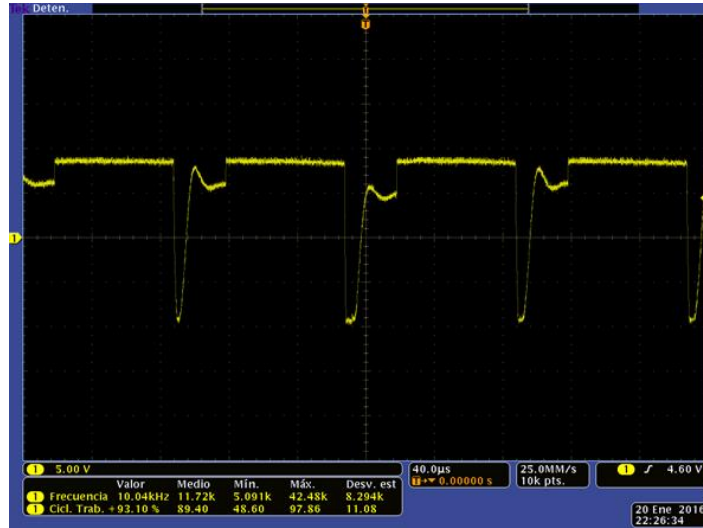
Figura 7.6. Señal de salida en modo fast decay .
