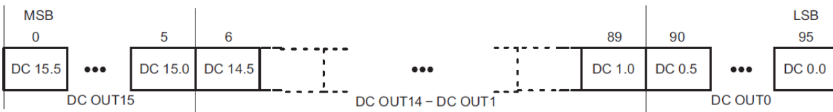
Figura 6.18. Estructura de los datos en el modo DC.
