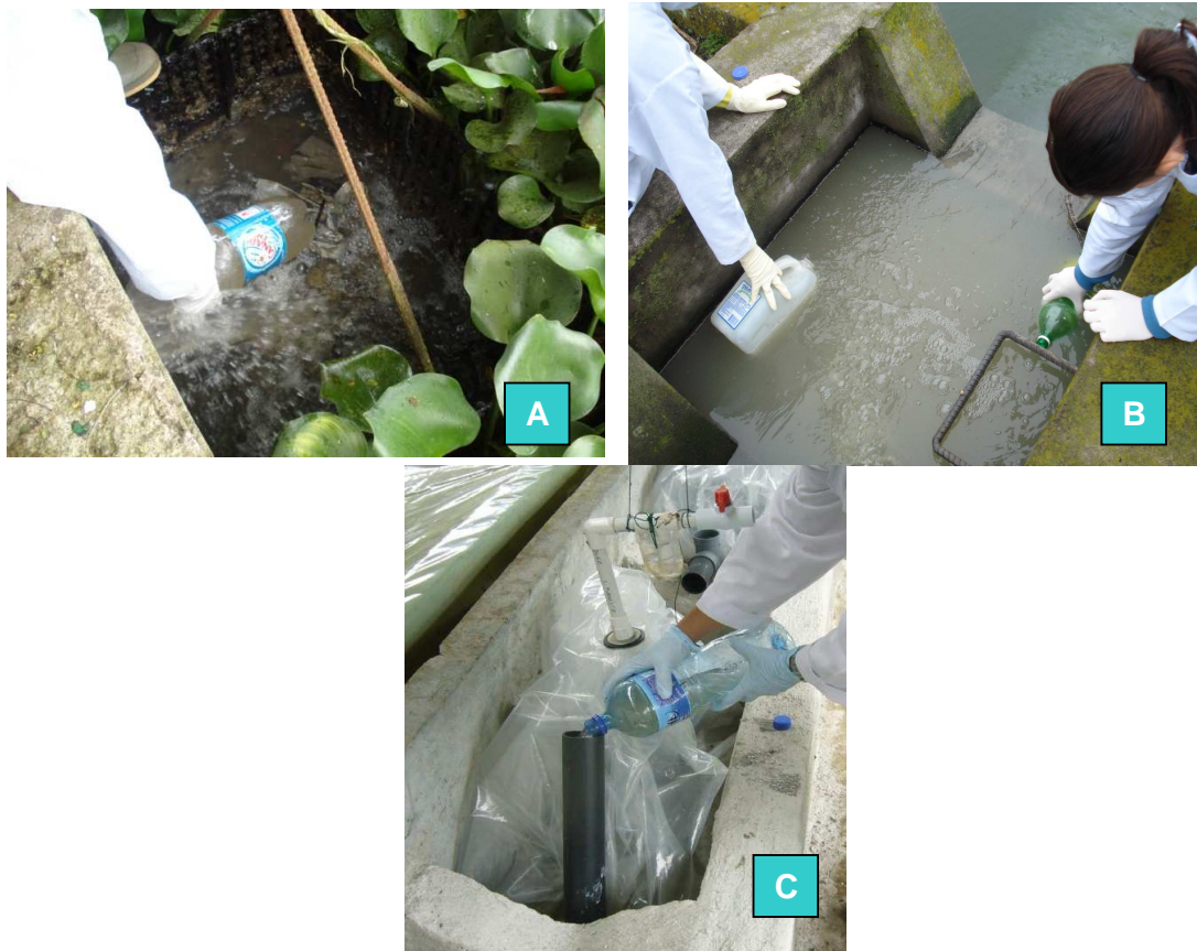
Figura 2. A. Muestreo de agua de la entrada a la laguna de tratamiento del ITCR. B. Muestreo de aguas de la entrada a la laguna de tratamiento del residencial Istarú. C. Alimentación manual de los biodigestores.
