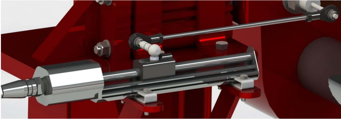
Figura 49. Propuesta de montaje del transductor de posición modelo MPA1/100SB01 (Fuente: Diseño propio en SolidWorks).
