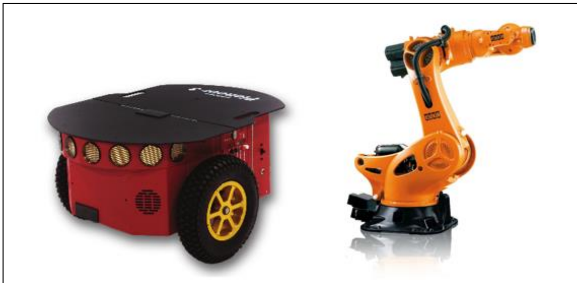
Figura 1. Robot móvil al lado izquierdo y robot estacionario al lado derecho. Recuperado de: (Mihai, 2015)
