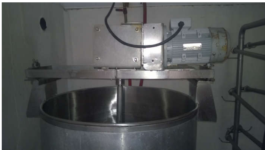
Figura 12 Motor para removedor de marmita. Tomada por: Diego Elizondo.
