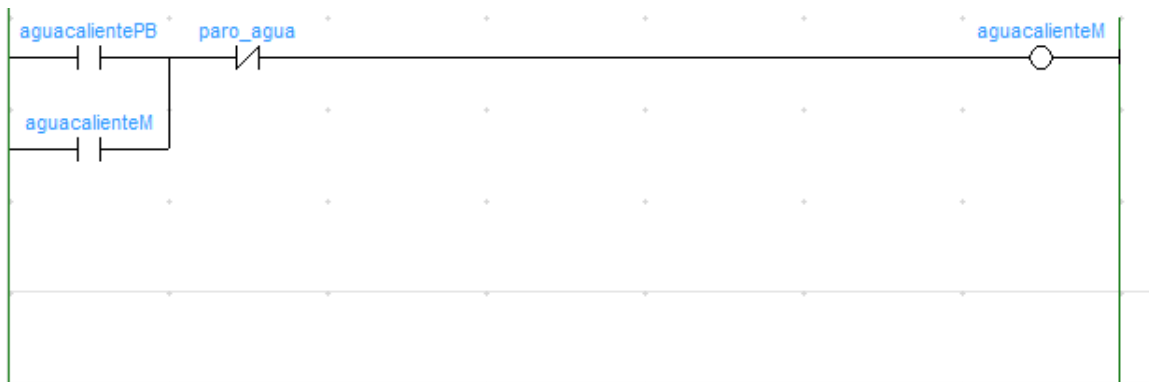
Figura 19. Diagrama de control para la bomba de agua caliente. Tomado de: CX-programmer.
