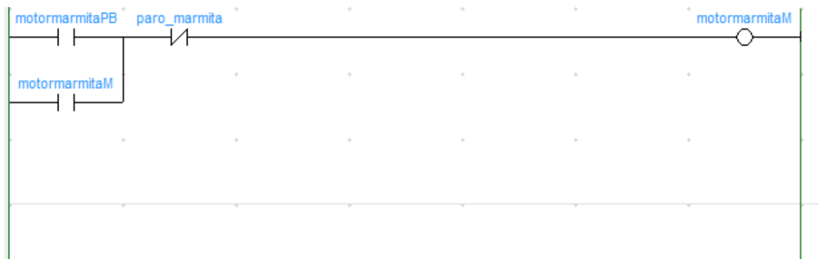
Figura 18 Diagrama de control para la marmita. Tomado de: CX-Programmer.
