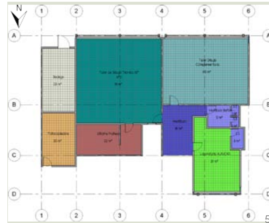
Planta de distribución del edificio de Dibujo Técnico de 10° año y Dibujo complementario
