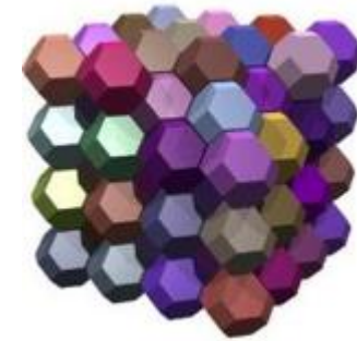
Imagen 30. Estructura de Weaire-Phelan, espuma poliédrica por octaedros truncados.
