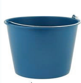
Recipiente de volumen conocido, adecuado para el caudal a medir
