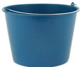
Recipiente de volumen conocido, adecuado para el caudal a medir
