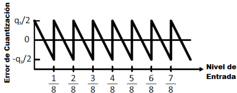
Figura 2.6. Muestra el Error de Cuantización. Adaptada de [3].
