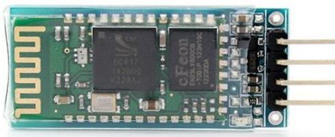
*Imagen 3.3: Tarjeta Bluetooth - serie utilizado en SiDiCo (HC-05)*
