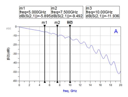
Figure 4.15 Transmission parameter magnitude for the link of example A (section 4.1.1**¡Error! No se encuentra el origen de la referencia.**) simulations. The three fundamental frequency for 10, 15 and 20 Gb/s are shown.
