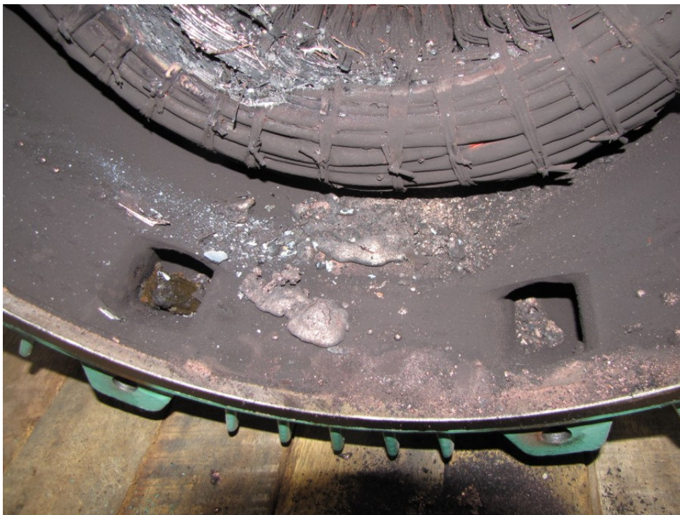
Fuente: Investigadores, Corto Circuito estator
