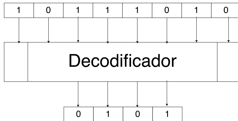
Figura 4.5: Diagrama de bloques RTL del decodificador necesario para realizar la suma.
