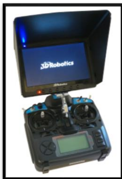
Figura 3.2 Control FlySky FS-TH9X con pantalla del kit FPV [37].
