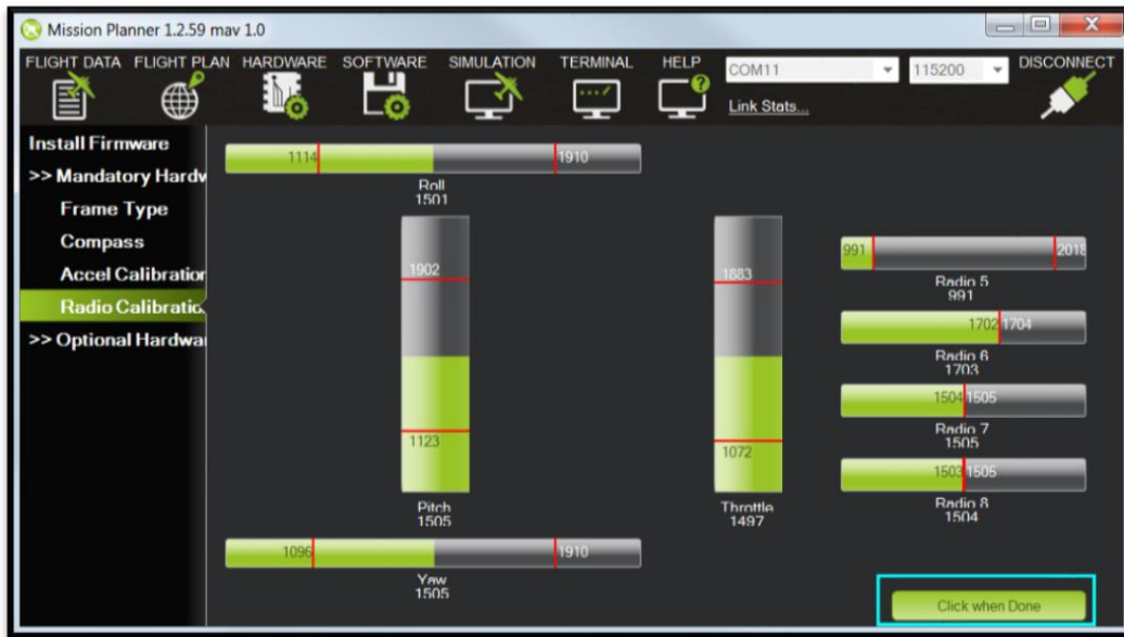
Figura A.14 Proceso de calibración del control.
