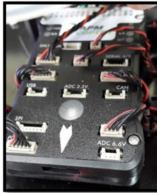
Figura 3.9 Plataforma Pixhawk conectada y montada en el X8+.
