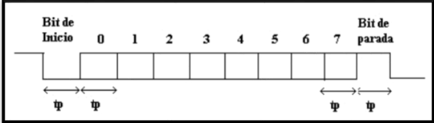
Figura 2.9. Formato de datos transmitidos en el protocolo UART [30].
