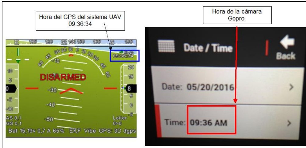
Figura 4.14 Sincronización de tiempos GOPRO y sistema UAV.
