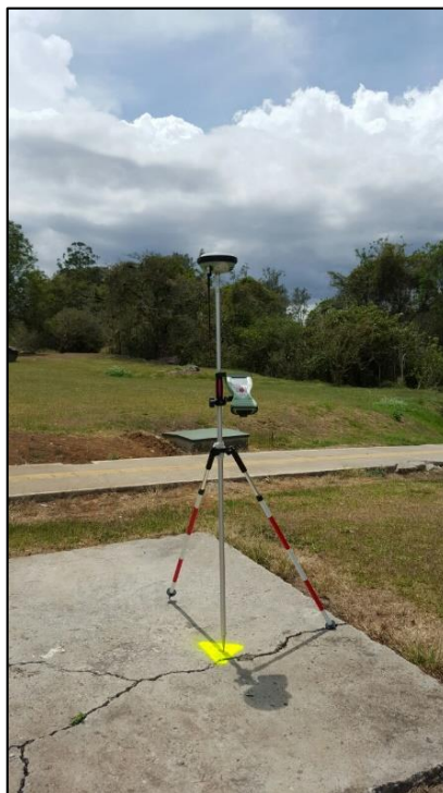
Figura F. 3 Utilización del sistema de posicionamiento RTK.
