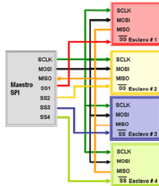
Figura 3. 3. Protocolo de comunicación SPI [1].
