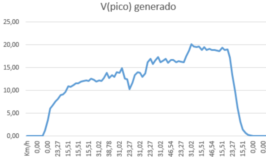
Figura 4.1: Comportamiento Dínamo Dansi a variaciones de velocidad
