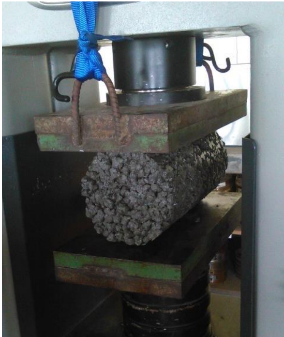
Figura 14. Prueba de tensión diametral.
