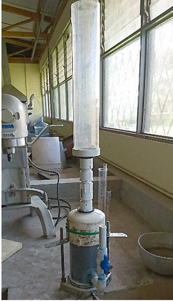
Figura 19. Permeámetro construido para la investigación.
