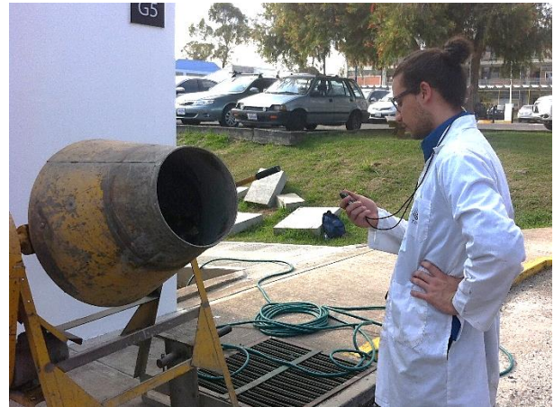
Figura 4. Proceso de mezcla del concreto permeable.
