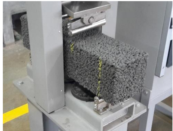
Figura 16. Prueba de flexión de viga según norma ASTM C78.
