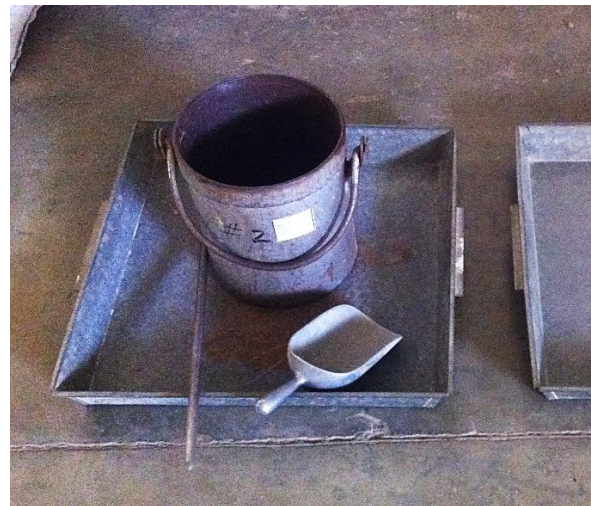
Figura 13. Equipo utilizado para prueba ASTM C1688.
