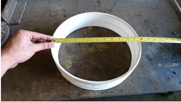
Figura 23. Aro de 70 mm de altura por 29,5 mm de diámetro utilizado en pruebas de infiltración.
