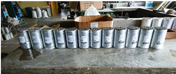
Figura 17. Cilindros preparados para pruebas de permeabilidad.
