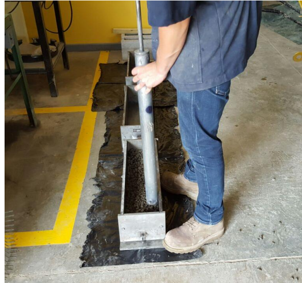
Figura 9. Compactación de primera capa de las vigas.
