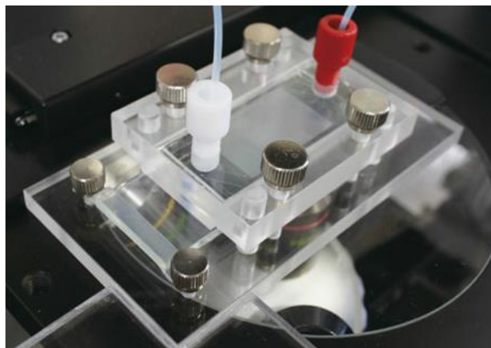
Figura 18. El CTC-chip se encuentra en el soporte para la inyección de la muestra de líquido [14].
