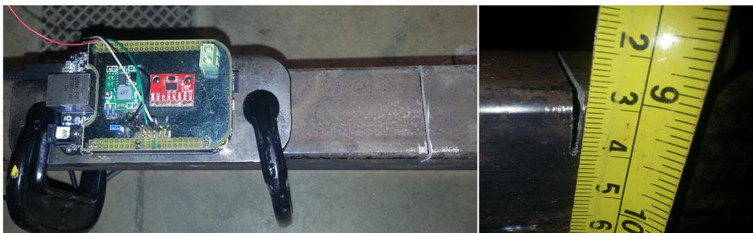
**Figura 5.6:** Profundidad y ubicación del daño en el perfil.
