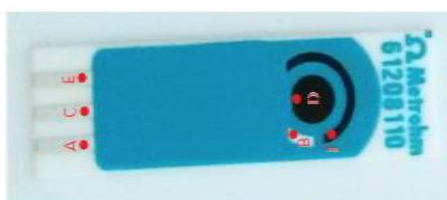
Figura 3.7: Electrodo Metrohm 61208210. Conexiones: A-B electrodo de referencia, C-D electrodo de trabajo, E-F electrodo de conteo.
