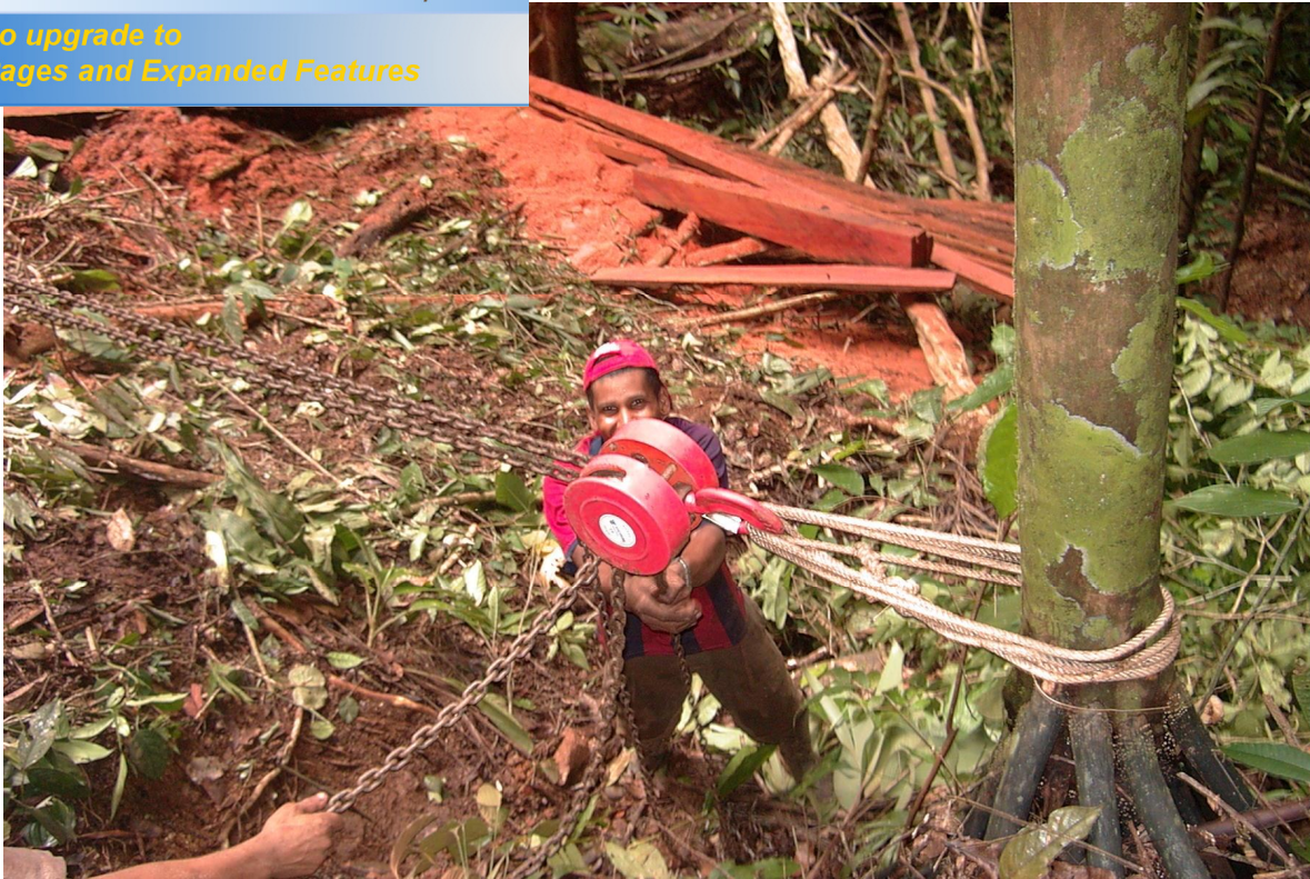
Figura 6. Acomodo de la madera para su procesamiento mediante el uso de teclas (catalina) en la Reserva Forestal Golfo Dulce, Costa Rica.
