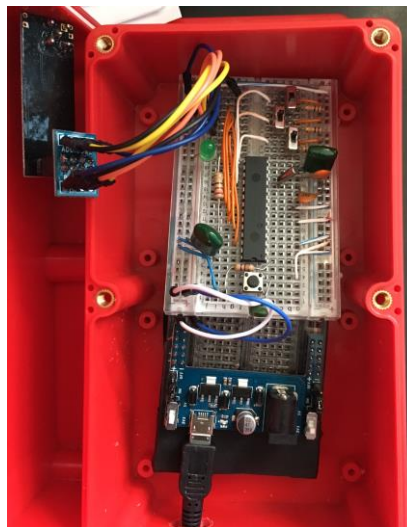
Figura 41. Nodo sensor SESbeacon utilizado para las pruebas de caracterización.
