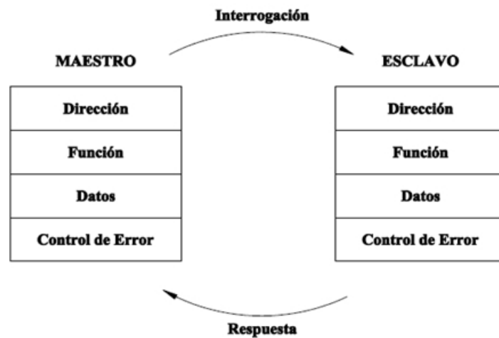
Figura 2.1 Formato de la comunicación de Modbus RTU. [1]
