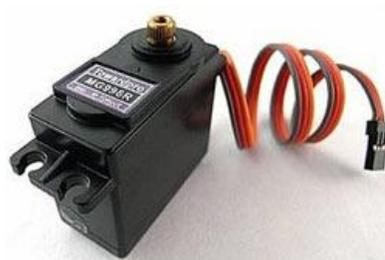
*Figura 5.12. Servomotor para eje de elevación*
