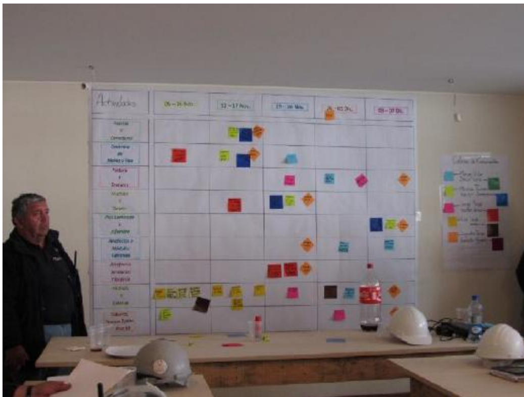
Figura 2. Colocación de hitos y compromisos en la pared. En la primera columna se colocan las actividades más próximas a ejecutar y las siguientes columnas corresponden a las semanas de planificación Look Ahead, que si se cuenta con el espacio necesario se pueden hacer pequeñas columnas que representen todos los días de las 4 semanas de planificación.
