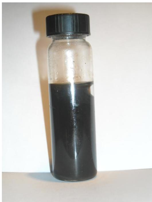
**Figura 5.** Muestra de aceite de pirólisis de policarbonato
