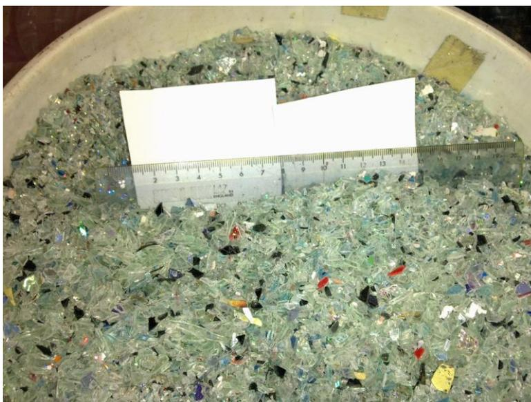
**Figura 4.** Discos Compactos después de molienda
