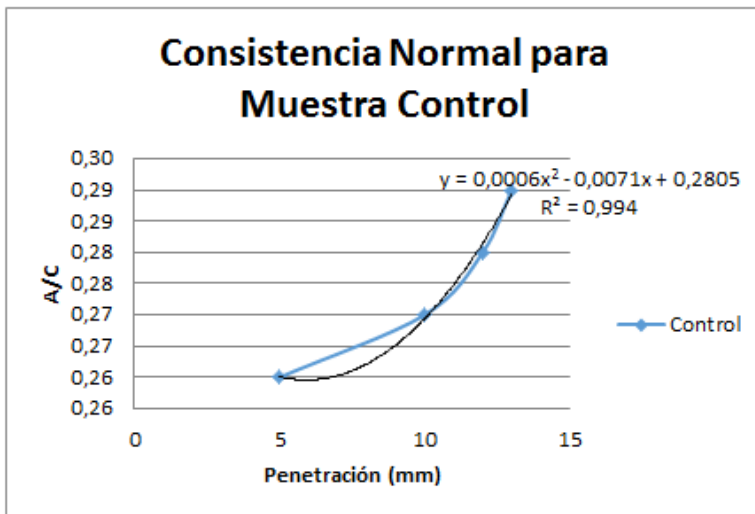
Figura 42. Representación gráfica de la demanda de agua para y cálculo de rango de consistencia normal para muestra control. (Fuente: cuadro 17)
