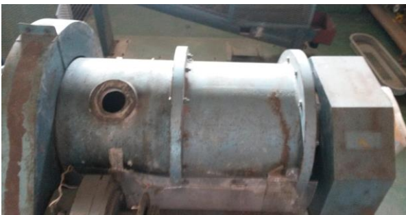
Figura 13. Unica entrada y salida para material del molino giratorio de esferas.
