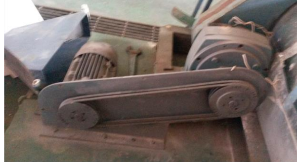
Figura 14. Motor y fajas adquiridas para el correcto funcionamiento del molino giratorio de esferas
