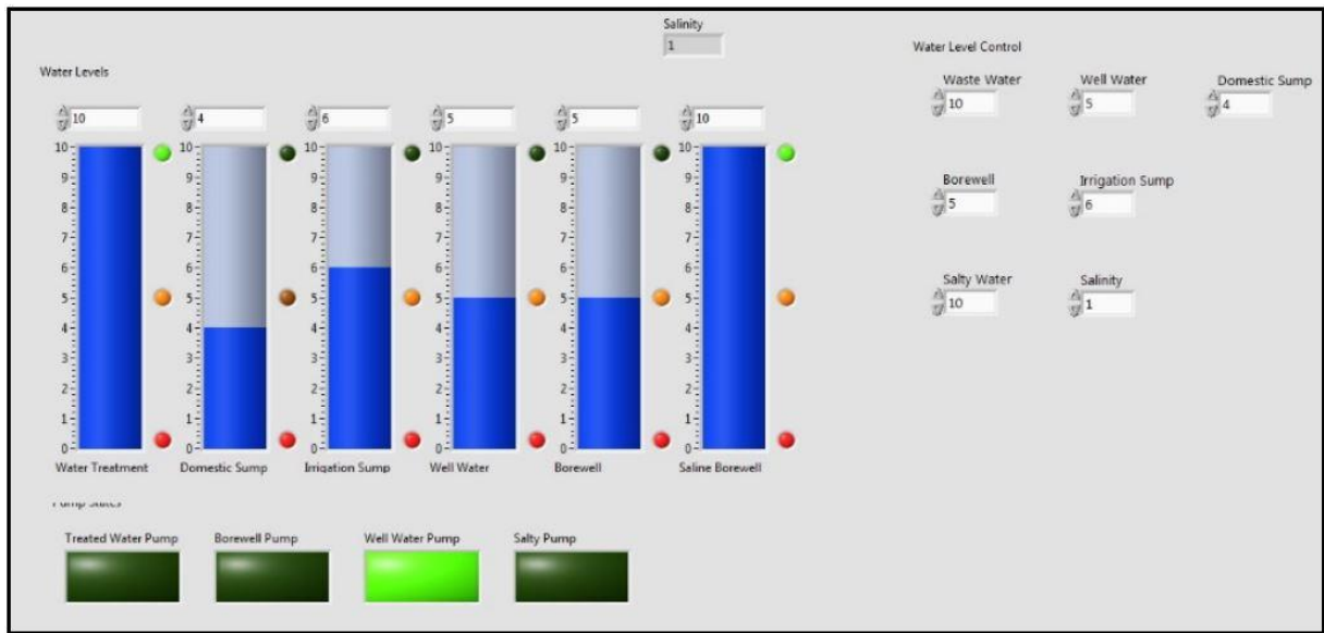
Figura 3.2 Interfaz gráfica desarrollada para el sistema de control de agua. Obtenido de [6].
