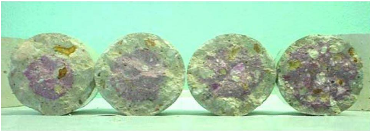
Figura 3.6 Cilindros de concreto rociados con fenolftaleína al 1%. Obtenido de [17].
