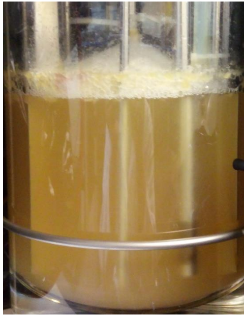
Figura 24. Comportamiento del flujo del medio y nivel de espuma en el biorreactor 1.
