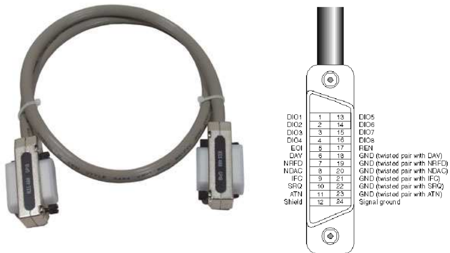
Figura 3.6 Conector y asignación de pines de GPIB [2]
