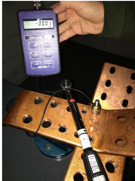
Ilustración 3 Ensamble de la unión roscada con un perno M10, indicador de potencia TR150 calibrado a cero y el torquímetro calibrado a 30 Nm.
