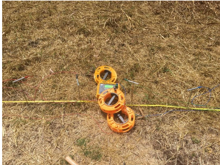
Figura 4.3. Disposición del equipo y los electrodos en la realización de las mediciones.
