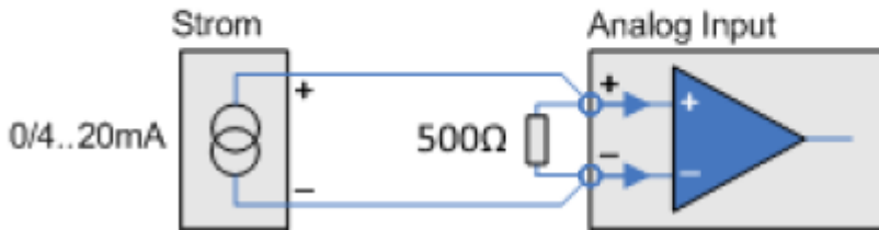
Figura 4.11 Sensores que generan señales de corrientes
