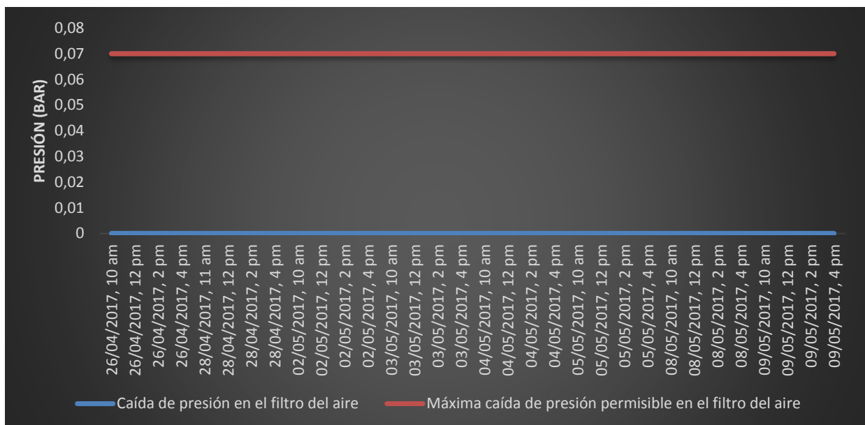
Gráfica 4.2 Caída de presión en el filtro de aire
