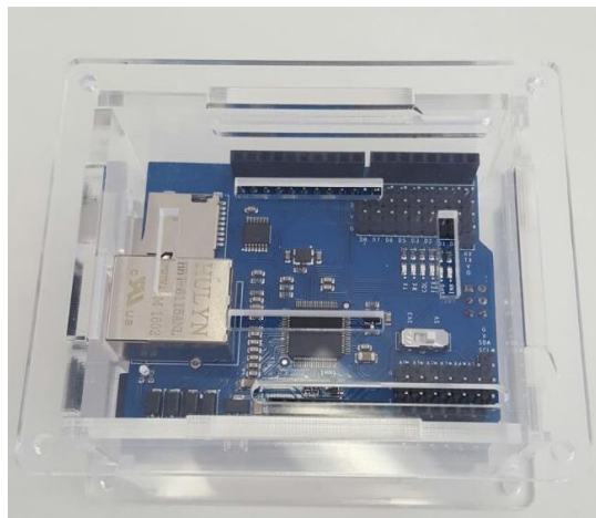
Figura 8.3 Arduino y tarjeta ethernet en la caja de acrílico
