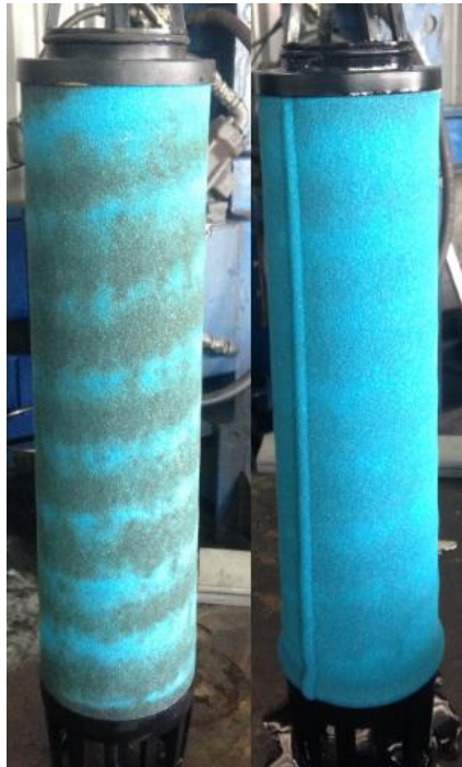
Figura 3.2 Limpieza de filtro de línea a la salida del compresor de 100 hp.
